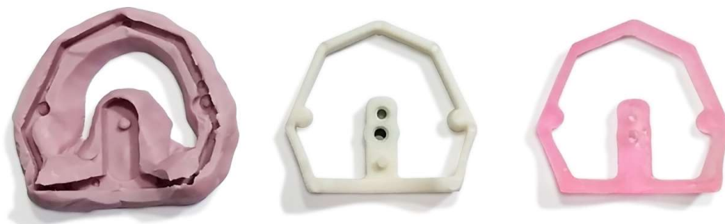
FIGURA 3 - Cópia da base plástica com silicona de condensação, base plástica do manequim odontológico e cópia da base confeccionada em resina acrílica autopolimerizável
