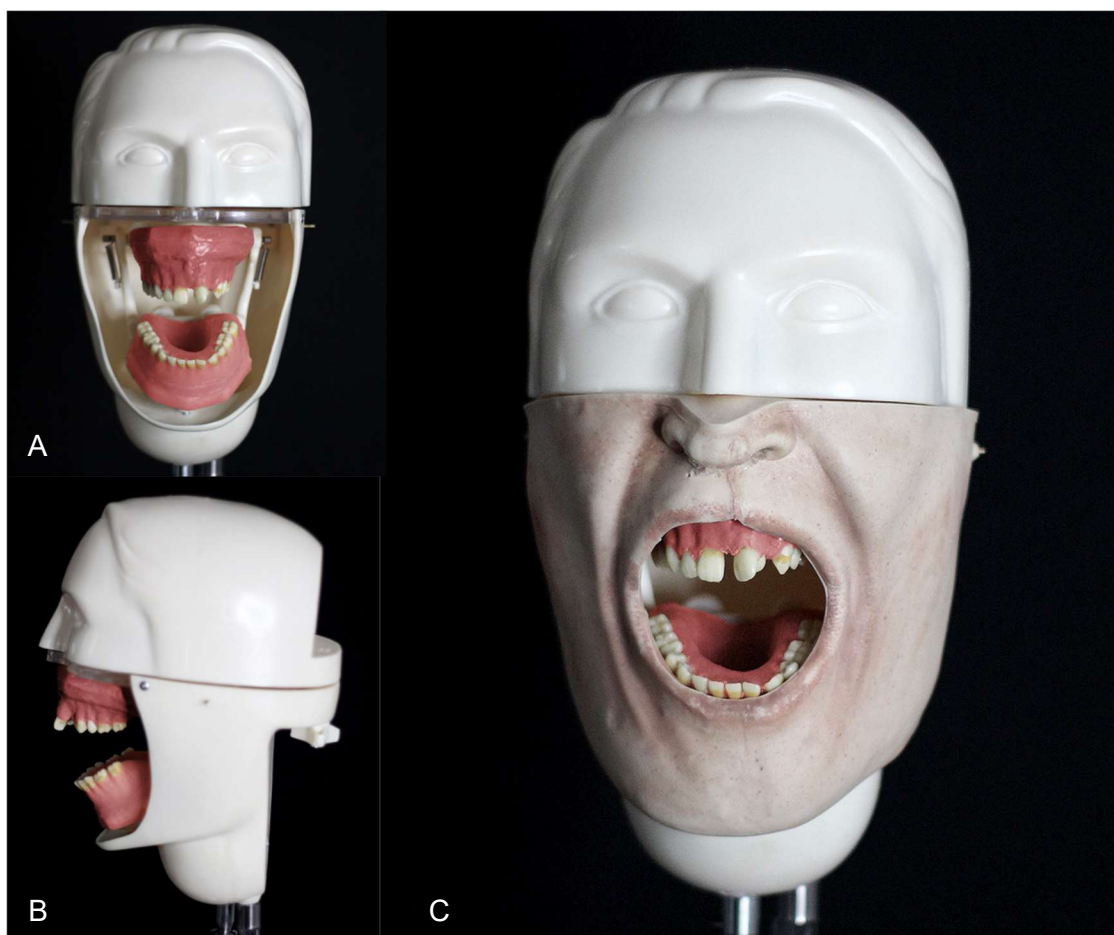
FIGURA 6 - A – Manequim odontológico em silicone adaptado à cabeça do simulador (vista frontal). B – Manequim odontológico em silicone adaptado à cabeça do simulador (vista lateral). C – Simulador finalizado.
